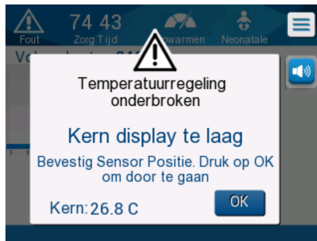
Afbeelding 33: Bericht temperatuurregeling onderbroken
