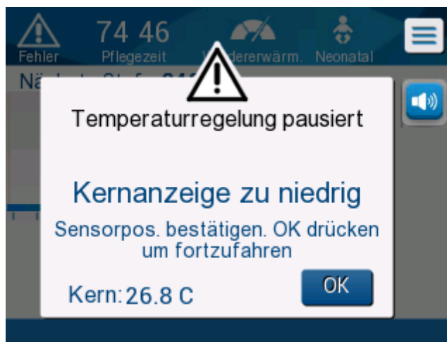
Abbildung 40: Modus „Kontrolliert Erwärmung“: Meldung „Kernanzeige zu niedrig“.
