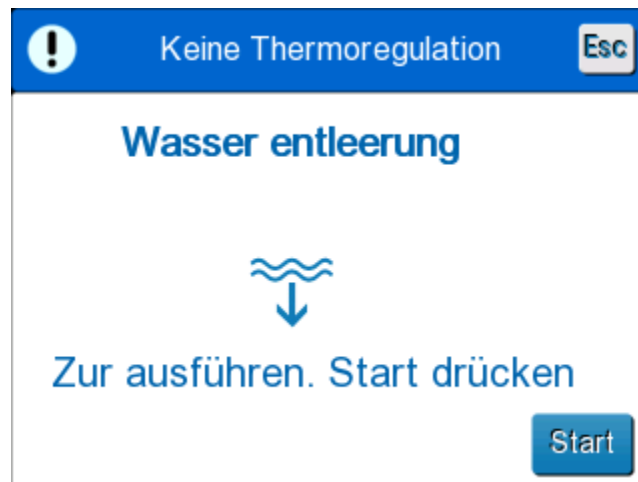
Abbildung 25: Bedienfeld zum Starten der Entleerung.
