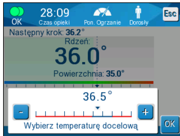
Ilustracja 30: Panel ustawiania temperatury docelowej
