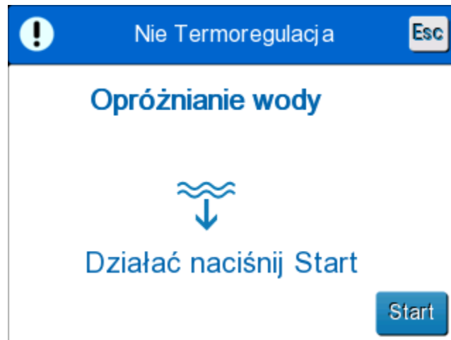
Ilustracja 25: Panel rozpoczęcia opróżniania.
