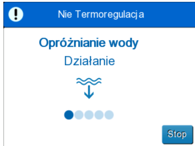
Ilustracja 26: Opróżnianie wody — panel wykonywania działania.
