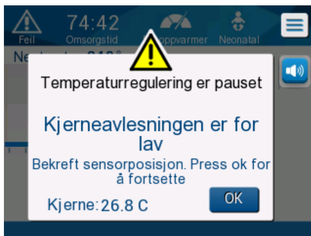
Figur 40: Modus for kontrollert gjenoppvarming: Meldingen Kjerneavlesningen er for lav.
