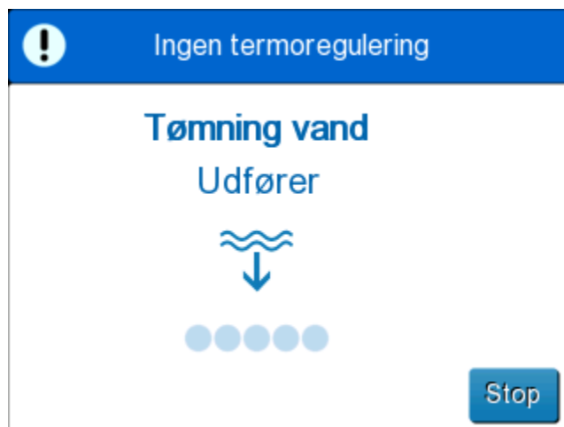
Figur 26: Tømning af vand – udførelsespanel.
