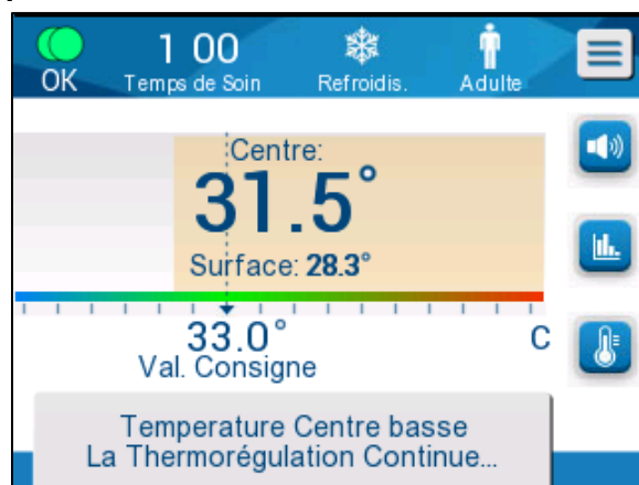
Figure 37 : Message Température centrale basse.
