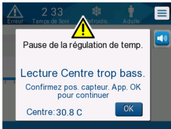
Figure 38 : Mode Refroidis. Message Température centrale trop basse.
