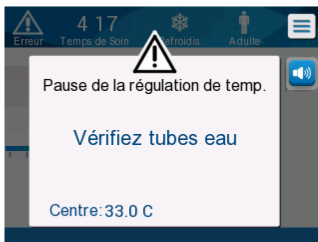
Figure 27 : Vérifier les tubes à eau
