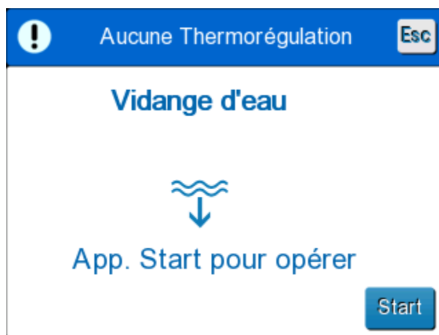
Figure 25 : Panneau de démarrage de la vidange.
