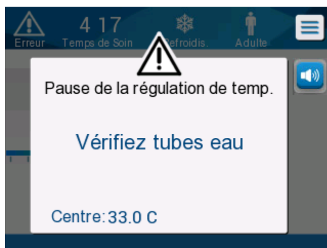
Figure 27 : Vérifier les tubes à eau
