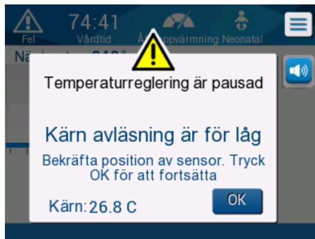
Bild 33: Meddelande om Temperaturreglering är pausad
