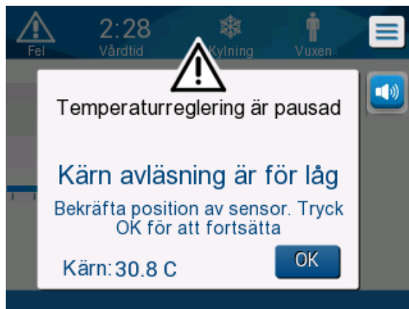
Bild 38: TTM-läge: Meddelande om för låg kärnavläsning.
