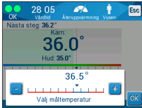
Bild 30: Inställningspanel för måltemperatur
