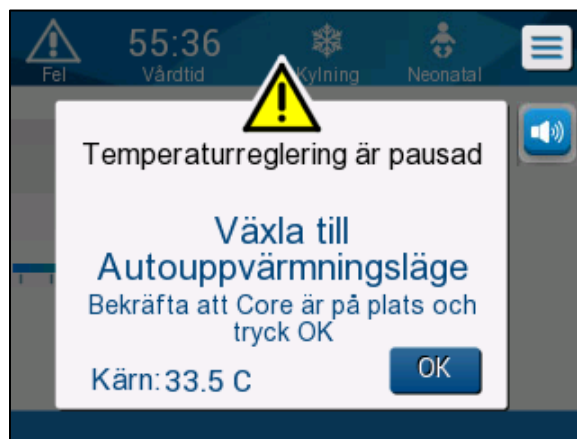
Bild 29: Meddelande om Växla till Autouppvärmningsläge.
