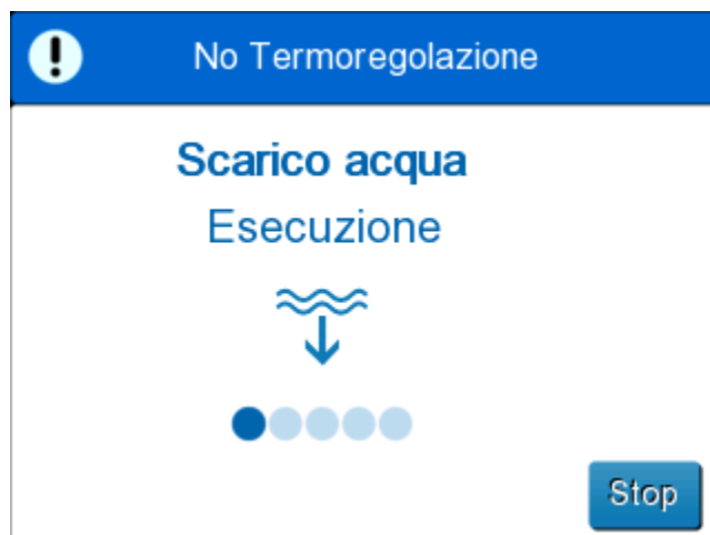
Figura 26: Pannello di esecuzione dello svuotamento dell'acqua.
