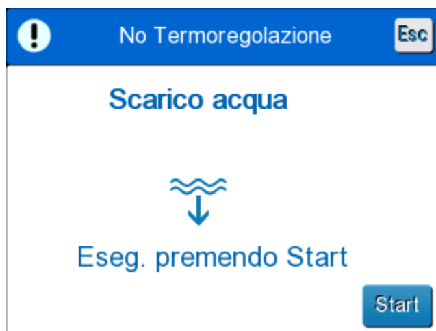
Figura 25: Pannello di avvio dello svuotamento.
