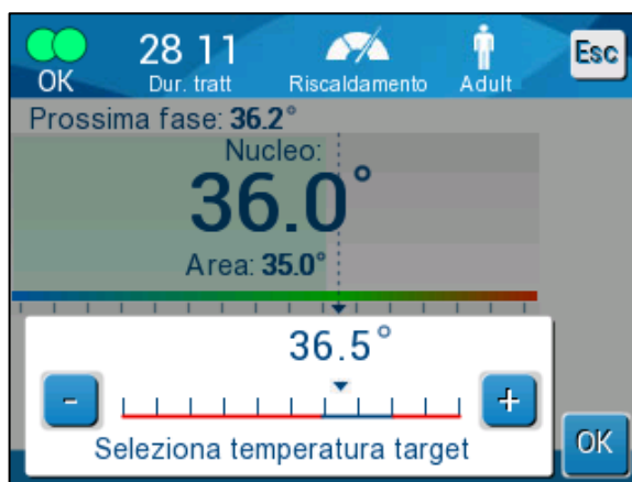
Figura 30: Pannello di impostazione della temperatura target
