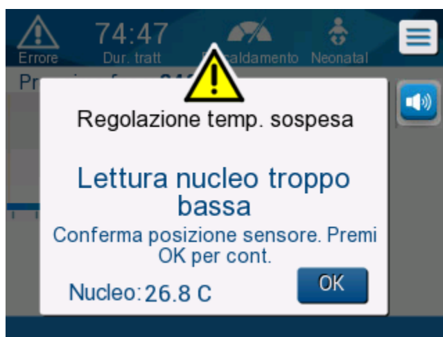
Figura 33: Messaggio di pausa nella regolazione della temperatura
