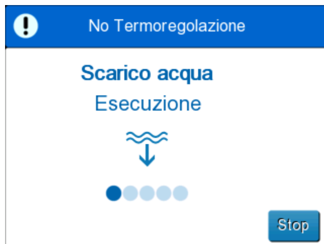
Figura 26: Pannello di esecuzione dello svuotamento dell'acqua.
