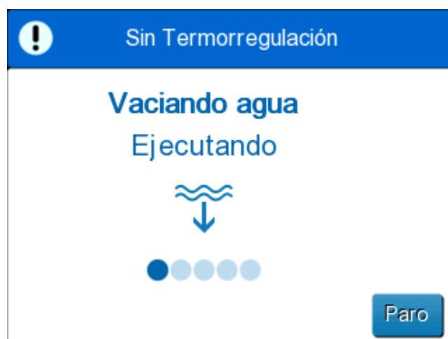
Figura 26: Panel de Vaciado de agua - En curso.
