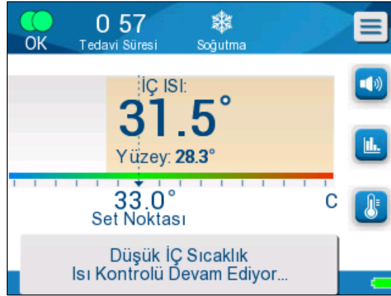
Şekil 37: Düşük İç Sıcaklığı Alarmı
