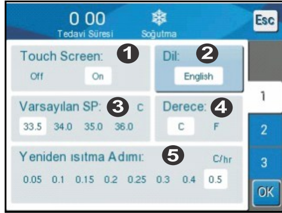
Şekil 14: Yeniden Isıtma Adımının Seçilmesi
