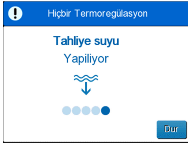
Şekil 29: Su ile Çalışan Panelin Boşaltılması
