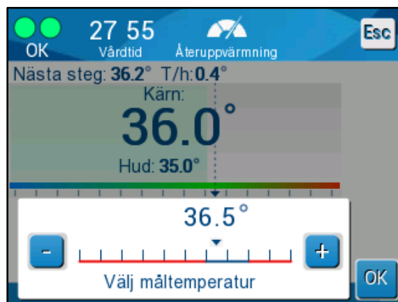
Bild 21: Inställningspanel för måltemperatur
