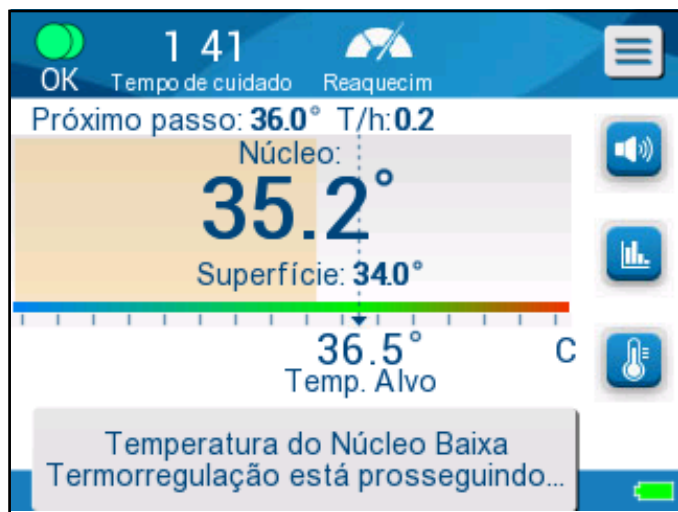
Figura 34: Alarme de Baixa Temperatura Do Núcleo
