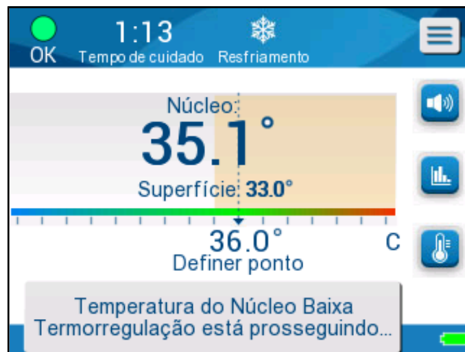
Figura 31: Alarme de baixa temperatura do núcleo
