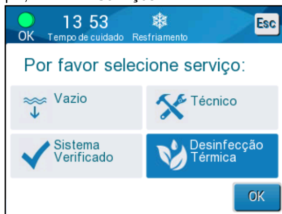
Figura 43: Seleção do serviço de desinfecção térmica
