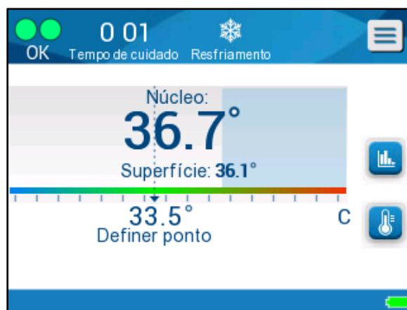
Figura 30: Painel principal com ID do sistema
