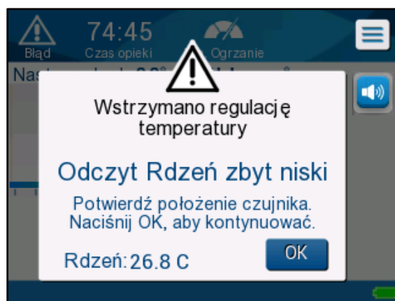
Ilustracja 41: Komunikat o zbyt niskim odczycie temperatury wnętrza
