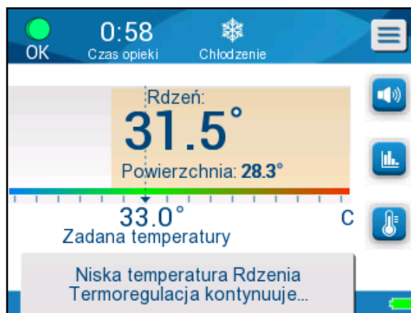
Ilustracja 15: Krok ponownego ogrzewania na ekranie głównym
