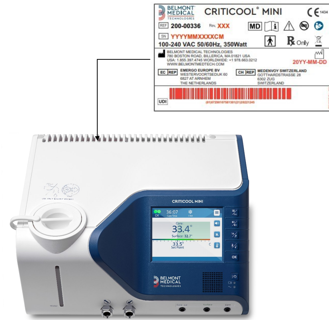
Ilustracja 1: Rozmieszczenie etykiet na urządzeniu CritiCool® MINI
