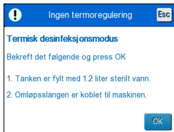
Figur 44: Slik setter du i gang termisk desinfeksjon
