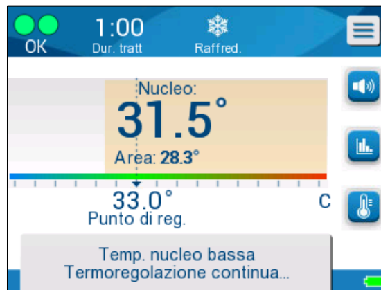
Figura 37: allarme di temperatura interna bassa
