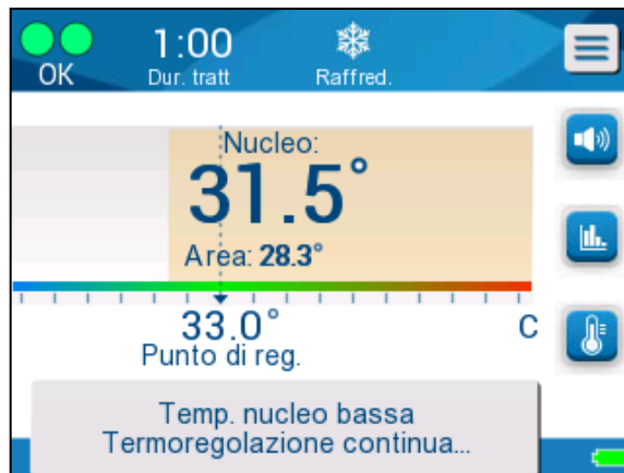
Figura 40: allarme di temperatura interna bassa
