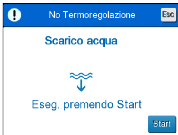
Figura 34: pannello di avvio dello svuotamento
