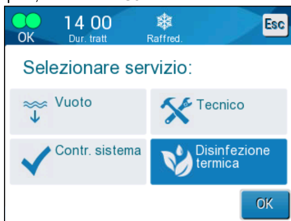
Figura 43: selezione del servizio di disinfezione termica
