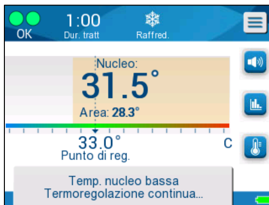
Figura 37: allarme di temperatura interna bassa
