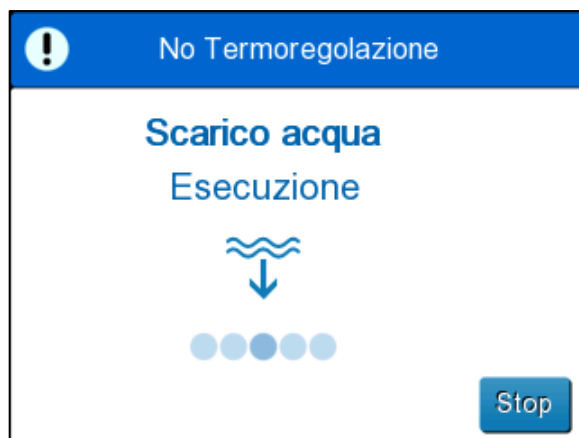
Figura 35: pannello di esecuzione dello svuotamento dell'acqua
