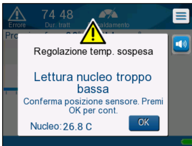
Figura 24: messaggio di pausa nella regolazione della temperatura
