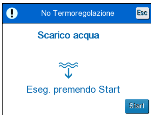
Figura 34: pannello di avvio dello svuotamento
