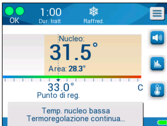
Figura 40: allarme di temperatura interna bassa
