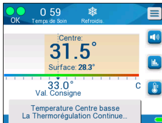
Figure 37 : Alarme de température centrale basse
