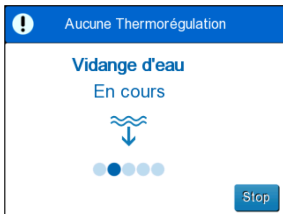
Figure 35 : Panneau Vidange de l'eau en cours
