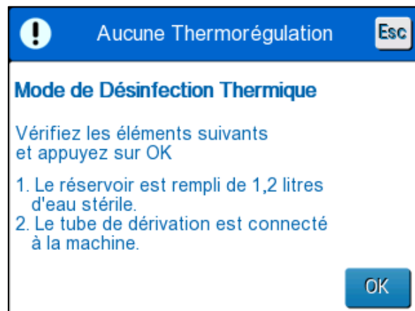
Figure 44 : Lancement de la désinfection thermique
