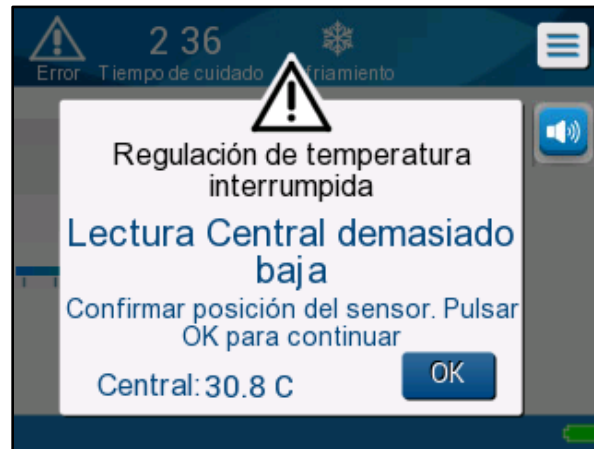
Figura 38: Regulación de temperatura en pausa. Mensaje de Lectura de temperatura central demasiado baja.
