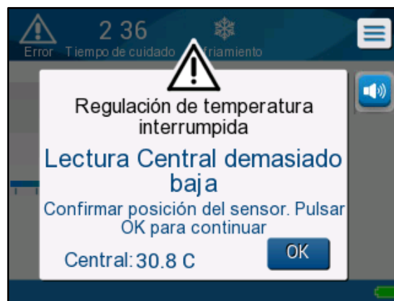
Figura 41: Mensaje de Lectura de temperatura central demasiado baja.
