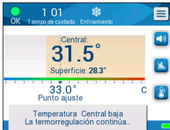
Figura 40: Alarma de temperatura central baja
