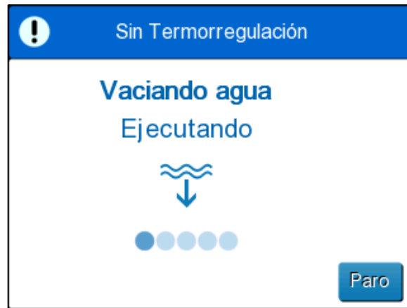
Figura 35: Panel de Vaciado de agua: en curso.
