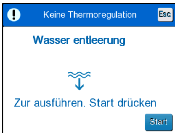
Abbildung 34: Bedienfeld zum Starten der Entleerung.
