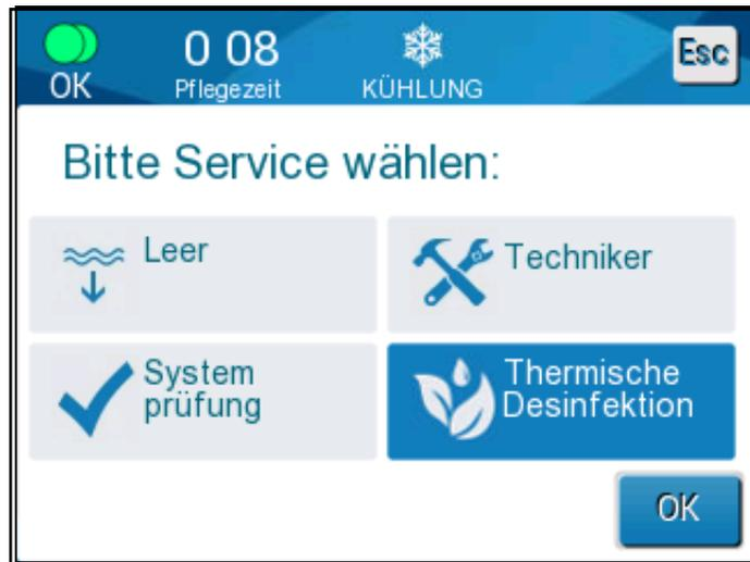
**Abbildung 37: Auswahl der Serviceoption „Thermische Desinfektion“**
