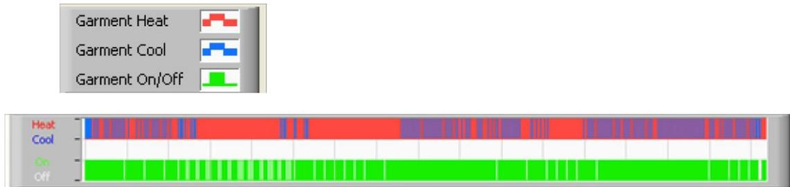
„Wärmen/Kühlen“ – Wenn CritiCool® MINI das Wasser im Tank kühlt, ist die Linie blau. Wenn das Gerät das Wasser im Tank erwärmt, ist die Linie rot.
