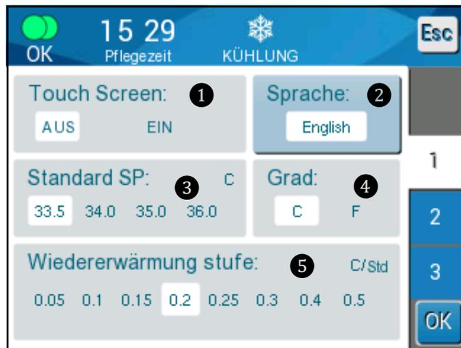
**Abbildung 13: Auswählen einer Wiedererwärmstufe**
