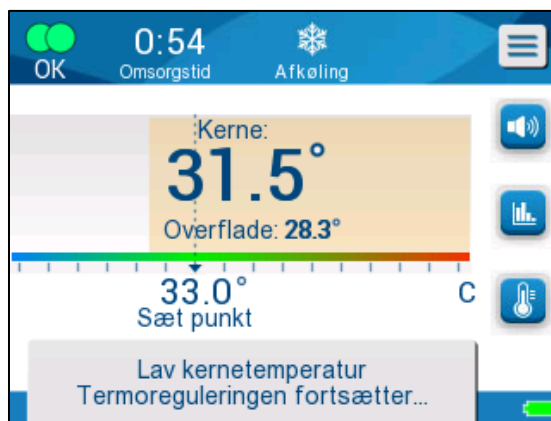
Figur 37: Alarm for lav kernetemperatur
