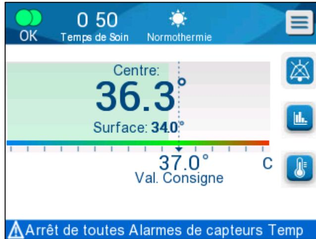
**Figure 27 : Indicateur Toutes alarmes capteurs temp inactives**
