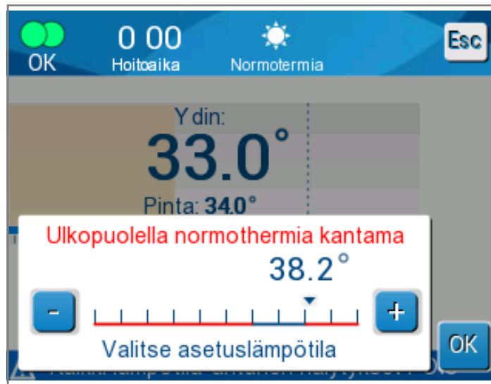
Kuva 21: "Normaalilämmön ulkopuolella" -viesti
