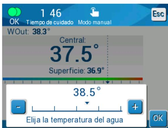
**Figura 23: Seleccionar temperatura de salida de agua**
