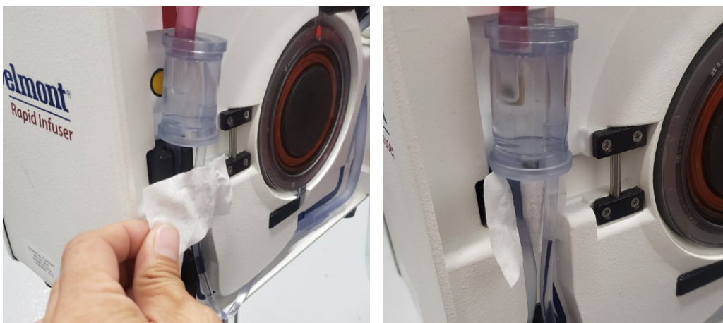
Hârtia este introdusă în detectorul de aer.
