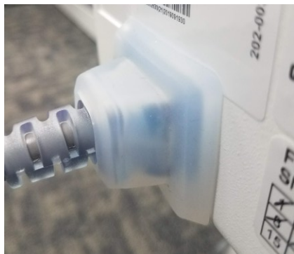
Fuktbeskyttelse og strømledning
