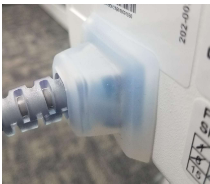
Protección antihumedad y cable de alimentación
