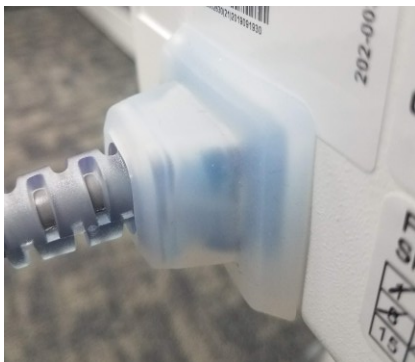
Feuchtigkeitsschutz und Stromkabel
