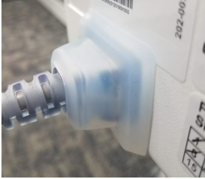
Vochtkap en stroomkabel
