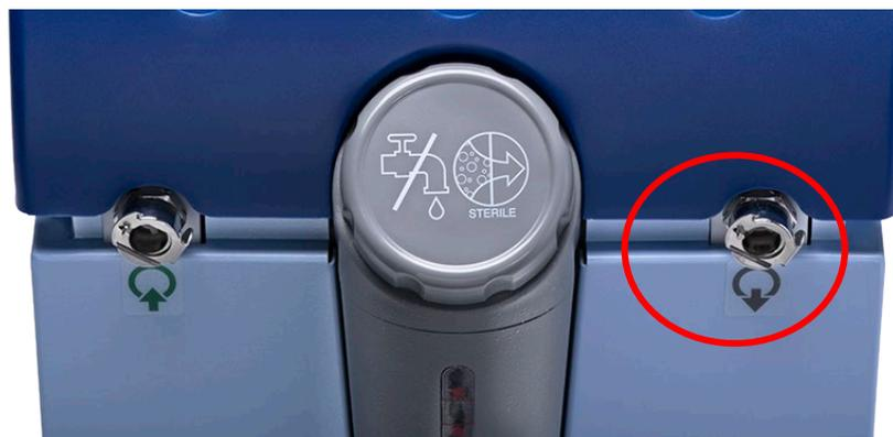
Zum Beheben drücken Sie „Esc“ auf dem Bildschirm. Merken Sie sich, welcher Schlauch sich wo befand, trennen Sie alle Verbindungswasserschläuche am Maschinenende und schließen Sie sie dann in umgekehrter Reihenfolge wieder an. Der Stecknippel zum Entleeren sollte nun an den Schlauch im Wasserablauf angeschlossen sein. Wiederholen Sie zum Schluss die vorherigen Schritte, um die Entleerung fortzusetzen.
