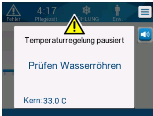
**Abbildung 27: Prüfen Wasserröhren**
