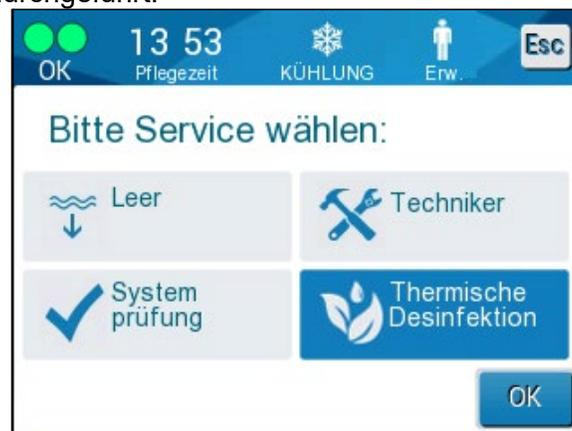
Die thermische Desinfektion von CritiCool® ist eine integrierte Funktion, bei der das zirkulierende Wasser im System erhitzt wird und auf diese Weise die internen Wasserleitungen des Systems, einschließlich des Wassertanks, desinfiziert werden.
