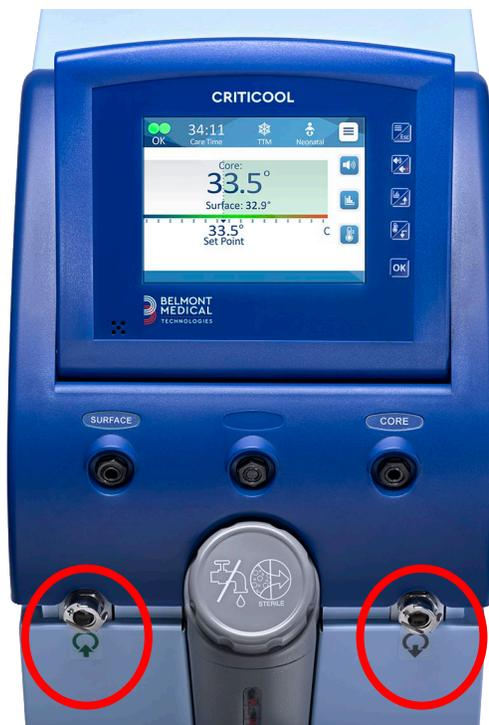
Unterhalb der Buchsen für den Kern- und den Oberflächentemperaturfühler befinden sich zwei Schnellkupplungen:
