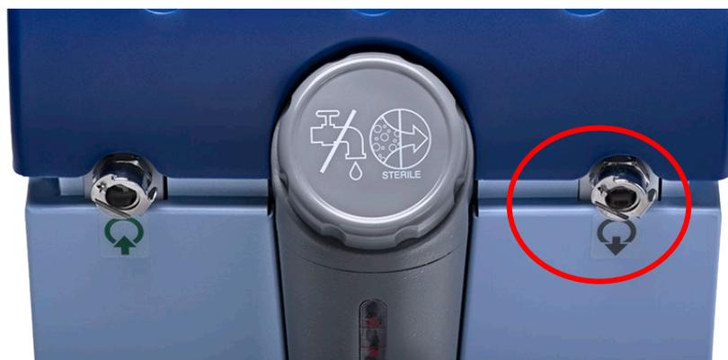
Pour résoudre le problème, appuyer sur « Esc » à l'écran. En gardant à l'esprit l'emplacement de chaque tube, déconnecter chaque tube d'eau à l'extrémité de la machine, puis le reconnecter dans le sens inverse. Le connecteur de vidange mâle doit maintenant être connecté au tube inséré dans la sortie d'eau. Une fois cette opération terminée, suivez à nouveau les étapes précédentes pour poursuivre la vidange.
