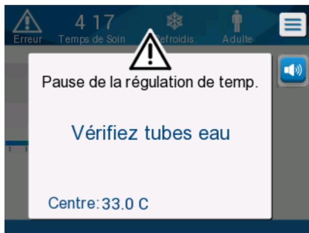
**Figure 27 : Vérifier les tubes à eau**
