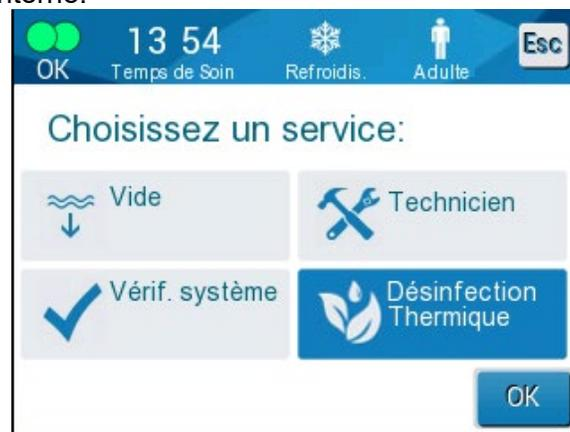
La désinfection thermique du dispositif CritiCool® est une fonction intégrée qui chauffe l'eau en circulation du système, permettant ainsi à la chaleur de désinfecter le circuit d'eau interne du système, y compris le réservoir d'eau.
