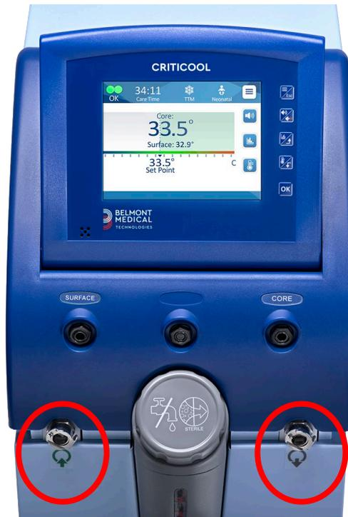
Il y a deux connecteurs d'accouplement rapide sous les prises de la sonde de température centrale et de la sonde de température de surface :
