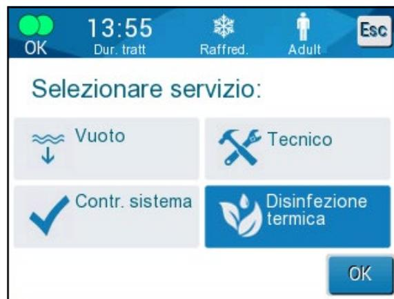
La termodisinfezione di CritiCool® è una funzionalità integrata, che riscalda l'acqua circolante nel sistema, permettendo così al calore di disinfettare le vie interne del sistema per l'acqua, compreso il serbatoio dell'acqua.
