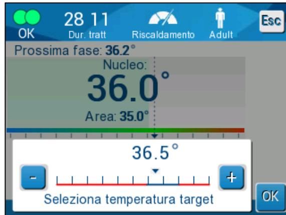
**Figura 30: Pannello di impostazione della temperatura target**
