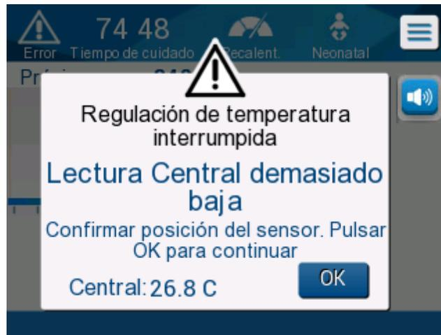
**Figura 40: Modo de recalentamiento controlado: Mensaje Lectura de temperatura central demasiado baja.**
