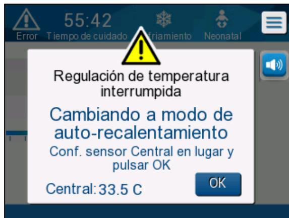
**Figura 29: Mensaje de cambio a recalentamiento.**
