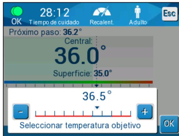
**Figura 30: Panel de ajuste de la temperatura objetivo**
