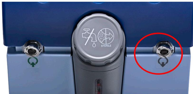
Para resolver, pulse “Esc” en la pantalla. Para mantener un registro de qué tubo estaba dónde, desconecte cada tubo de agua de conexión en el extremo de la máquina y, a continuación, vuelva a conectarlo de forma inversa. Ahora el conector de vaciado macho debe conectarse al tubo insertado en la salida de agua. Cuando se complete, siga los pasos anteriores una vez más para continuar con el vaciado.
