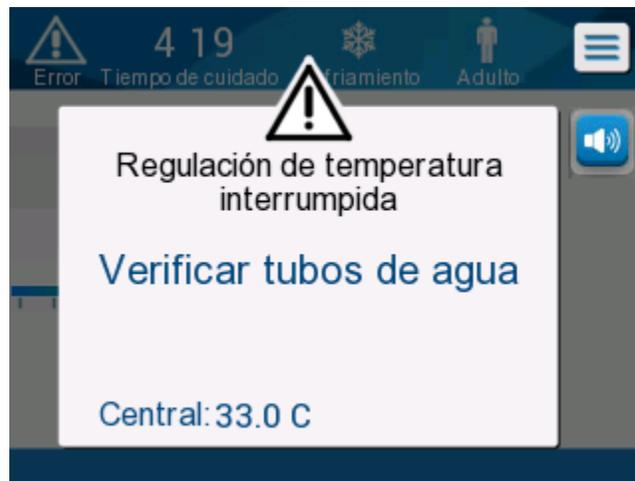
**Figura 27: Comprobar tubos de agua**
