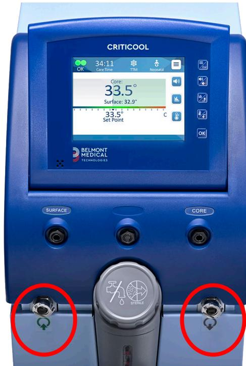
Hay dos conectores de acoplamiento rápido debajo de los enchufes de las sondas de temperatura de superficie y central:
