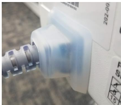
Fuktbeskyttelse og strømledning
