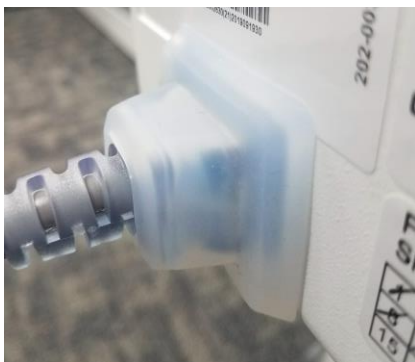
Fuktskydd och nätsladd
