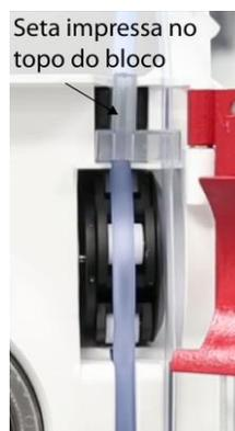
3. Posicione firmemente o bloco de interbloqueio no detetor de ausência de fluido.
