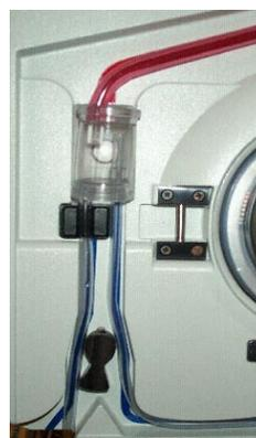
5. Coloque a câmara de pressão no encaixe da câmara de pressão. Insira firmemente a linha de perfusão mais larga no detetor de ar e à esquerda da haste da válvula.
