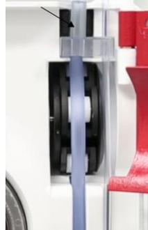
3. Posizionare saldamente il bloccetto di interblocco nel sensore di fluido esaurito.
