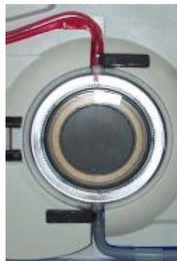
1. Inserire la camera del serbatoio nel morsetto di fissaggio del serbatoio.
