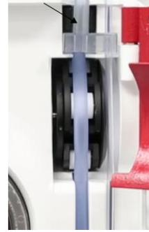
3. Den Interlock-Block fest auf den Detektor für Flüssigkeitsverluste aufsetzen.
