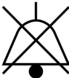
Alle Alarmer gelten als technische Alarmer mit hoher Priorität, mit Ausnahme der Meldungen bei niedrigem Akkustand und zur Druckkontrolle. Bei niedrigem Akkustand erscheint ein optischer Alarm wie unten beschrieben und es ertönt ein anderer akustischer Alarm, d. h. ein Piepton alle zehn Sekunden.
