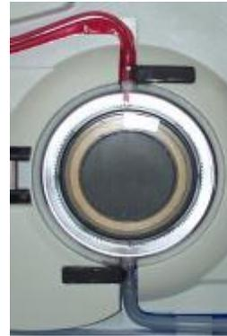
1. Behälterkammer in die Behälterstützklemme einrasten.
