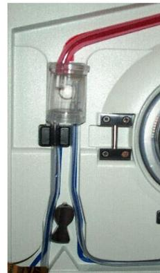
6. Die dünnere Rücklaufleitung rechts neben dem Luftsensor und rechts vom Ventil-Abtaster entlang führen.
