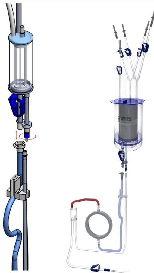
1. En utilisant une technique aseptique, retirer la chambre de réservoir du set jetable à 3 perforateurs en débranchant les connecteurs.
