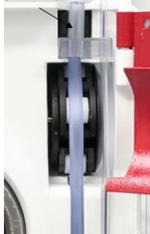
3. Positionner fermement le bloc de verrouillage dans le détecteur de fluide épuisé.
