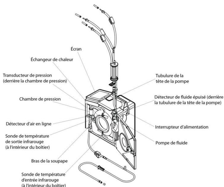
Schéma des principaux composants du système
