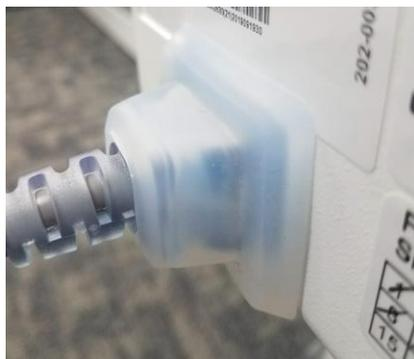
Cordon d'alimentation et mécanisme anti-humidité
