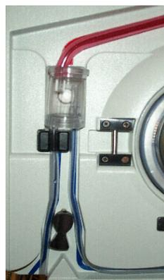
4. Collocare la camera di pressione nel suo pozzetto. Inserire saldamente la linea di perfusione più grossa (tubo con diametro esterno di 0,96 cm) nel sensore dell'aria e a sinistra della bacchetta della valvola.
