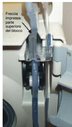
2. Posizionare saldamente il blocchetto di interblocco nel sensore di fluido esaurito.
