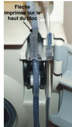
2. Positionner fermement le bloc de verrouillage dans le détecteur de liquide épuisé.
