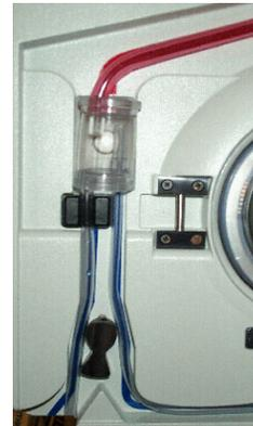
4. Placer la chambre de pression dans le puits de chambre de pression. Insérer fermement la ligne de perfusion plus large (tubulure de Ø ext. 0,96 cm) dans le détecteur d'air et sur la gauche du bras de la soupape.
