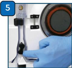
Coloque a linha de infusão à esquerda da varinha de válvula e a linha de recirculação mais fina à direita da ponteira da válvula
