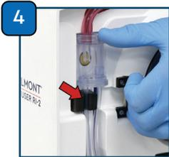
Coloque a câmara de pressão no espaço da câmara de pressão e pressione a linha de infusão para o interior do detetor de ar
