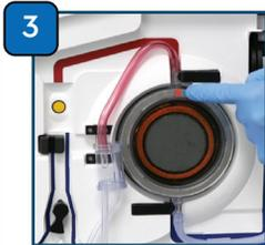
Carregue o permutador de calor circular com a seta vermelha a apontar para cima
